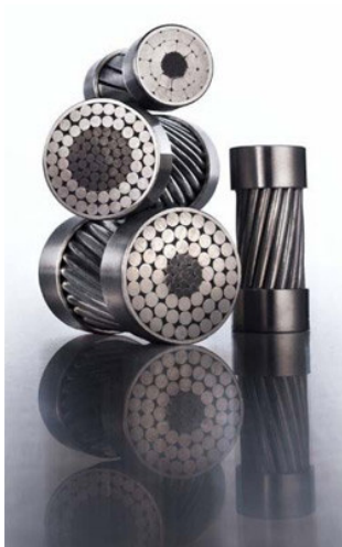
Рис.4 Провод типа ACCR - композитный сердечник, алюминиевые жилы, верхний слой из алюминия высокой проводимости
