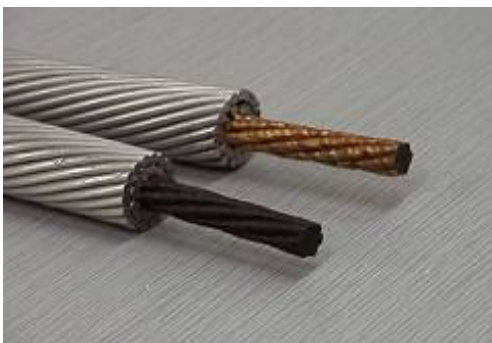
Рис.6 Провод типа ACFR - полимерный сердечник, упрочнённый углеродными волокнами, жилы алюминиевые
