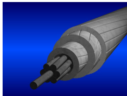
Рис.7 Провод типа GTASCR - с зазором, заполненным термостойкой смазкой со стальным сердечником, алюминиевые жилы трапециидального сечения
