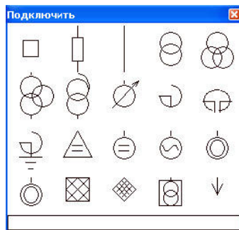
Рис. 2. Палитра объектов электрической сети
