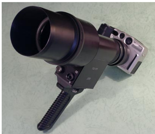
Рис.1 Внешний вид электронно-оптического дефектоскопа «Филин – 6М»
